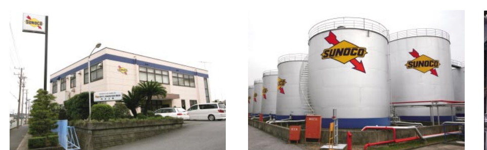
④敷地内にはベースオイルを保管するためのタンクヤードが林立する。その量1万2,000klに達するそうだ。ここから製造工場に導かれ、さまざまなオイルに加工されていく
