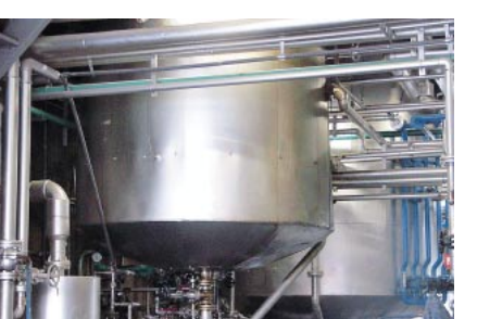
③これがベースオイルと添加剤を混ぜ合わせるための釜だ。その下部からドライエアを噴射し、その勢いでかくはんしていくのである。これによってエステルが持つ本来の性能をキープするので
